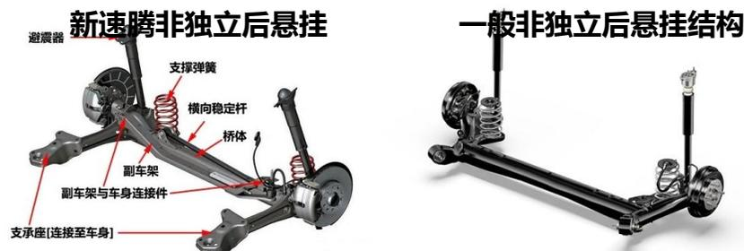
**结构**：新速腾非独立悬挂的扭力梁、减震弹簧、减振筒等安装位置与一般非独立悬挂明显不一致。
